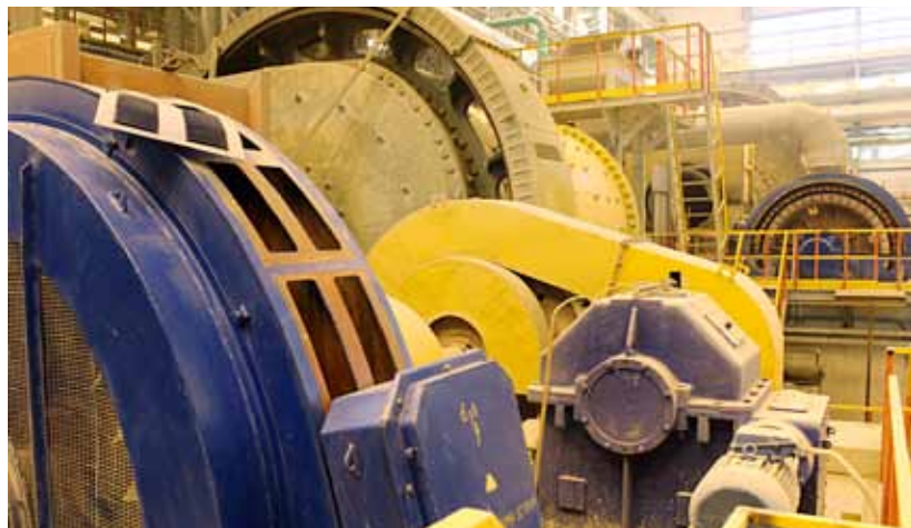
ГОК «Олений ручей» Электропривод (6кВ) шаровой мельницы
